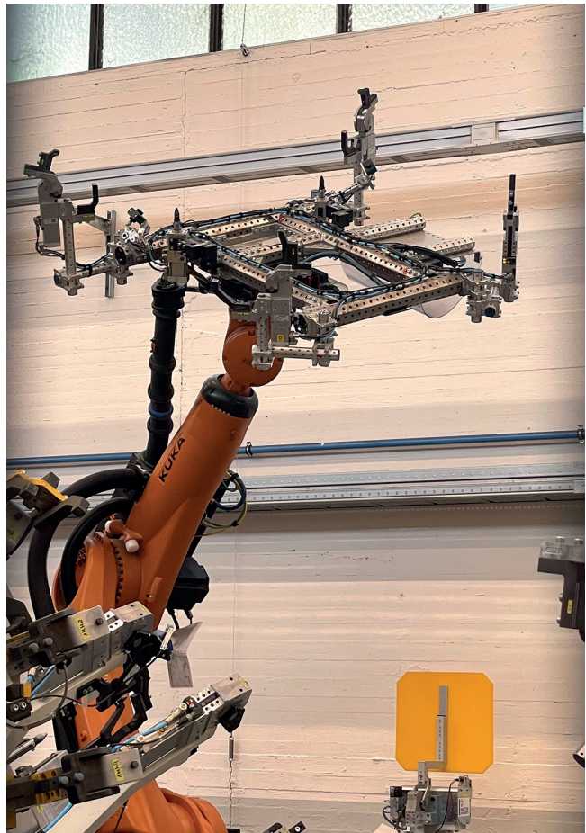
Ein Bauteilgreifer wird leichter und günstiger: Durch den Einsatz von hochfesten Aluminiumprofilen mit einer eigens entwickelten Stützkonstruktion gelang es, den Materialverbrauch und das Gewicht gegenüber dem ursprünglichen Strangpressbauteil aus Stahl deutlich zu verringern (Bild: PROFILMETALL GmbH)
